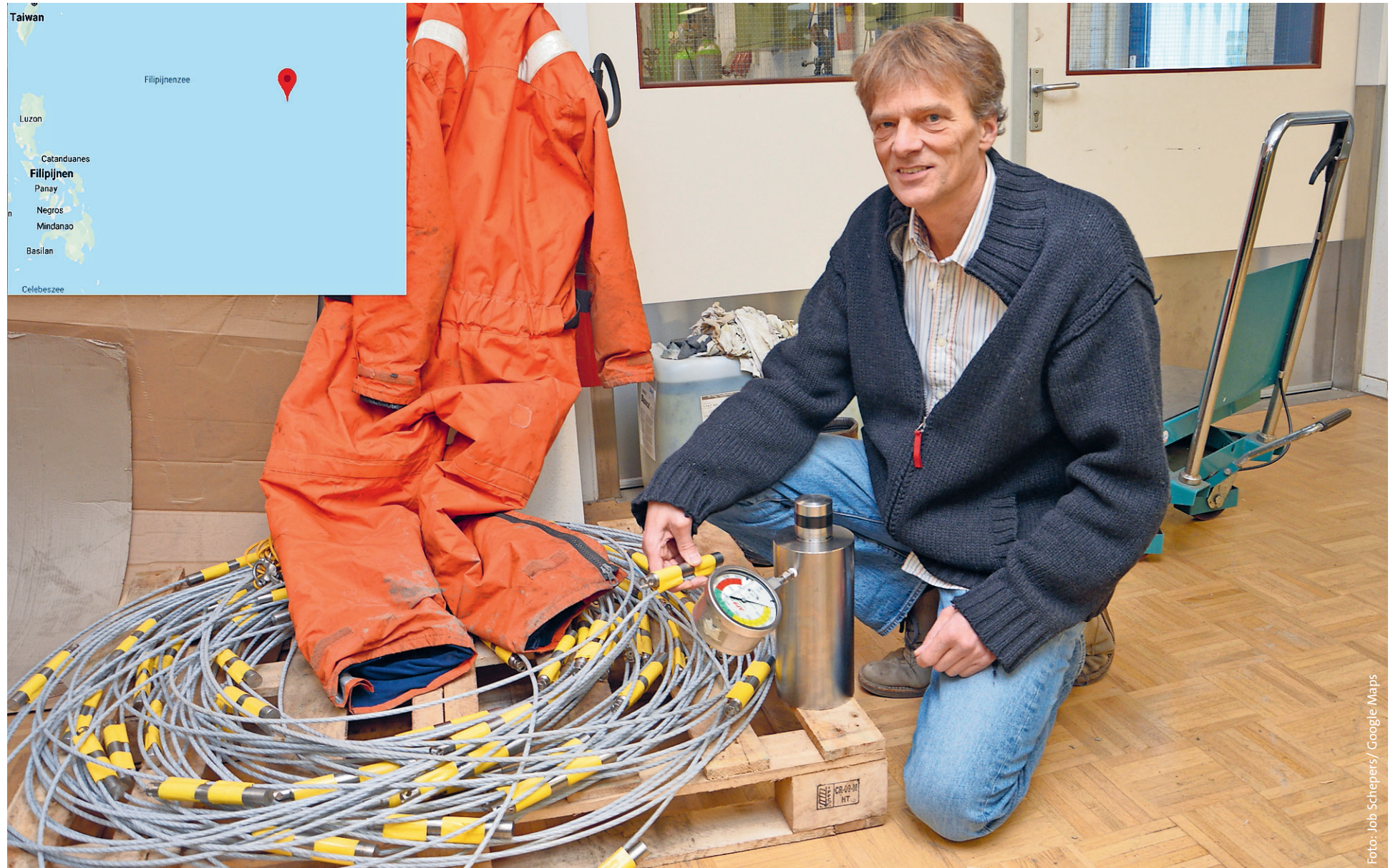
Hans van Haren met een deel van de 'sensorenlijn' en een testapparaat dat voor testen onder hoge druk kan worden gebracht. Linksboven, de ligging van de Marianentrog nabij de Filipijnen.
